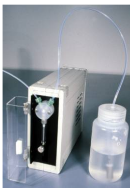
GeSiM-Spritzenpumpen "im richtigen Leben": Zwei-kanal-Dilutor mit Selektorventil zur Fluidiksteuerung der GeSiM-Mini-Durchflusszelle für das Mikroskop ("MicCell"), mit Windows-Steuerungssoftware
