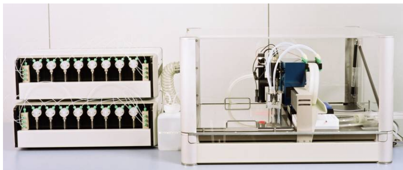
Unten: Mikropipettiersystem Nano-Plotter™ NP 2 mit 16 Kanälen, verbunden mit 2 Einheiten à 8 Dilutoren, welche die Fluidiksteuerung übernehmen
