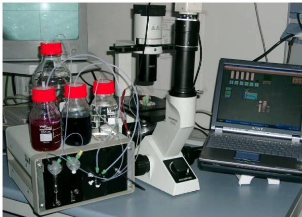
GeSiM-Spritzenpumpen "im richtigen Leben": Zwei-kanal-Dilutor mit Selektorventil zur Fluidiksteuerung der GeSiM-Mini-Durchflusszelle für das Mikroskop ("MicCell"), mit Windows-Steuerungssoftware
