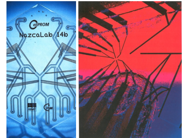
Mikroelektroden und Polymer-Kanalwände auf Glas zum berührungslosen Festhalten und Sortieren von Zellen per Dielektrophorese (rechts: Detail). Entwickelt für das EU-Projekt CellPROM (Koordinator: Fraunhofer IBMT).
