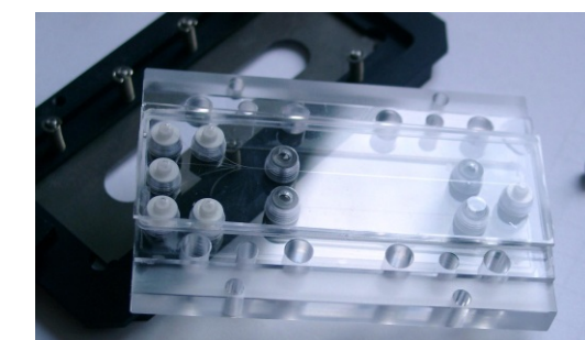
Große PDMS-Kanalplatte für ein Stereomikroskop. Der Kanal wird von einem Objektträger verschlossen.
