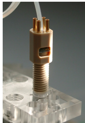
Das durch Weglassen einer gedruckten Leiterplatte autoklavierbare Hydrogelventil PV7 im MicCell-Deckel
