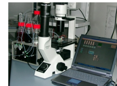
MicCell-Aufbau. Zu sehen ist eine Kanalplatte aus Glas mit aufstrukturiertem Polymerkanal; normalerweise besteht sie aus abgeformtem PDMS. Befestigungselemente und Arbeitsplatte (Adapter zum Mikroskop) sind nicht gezeigt.
