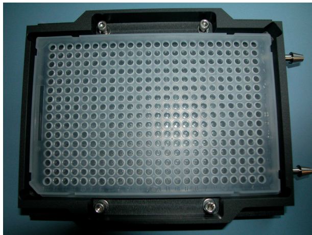
Abb. 1. Der Mikroplattenhalter (links). Sein Metallkörper wird von Kühlflüssigkeit durchströmt. Der Kühleffekt ist im rechten Diagramm zu sehen.
