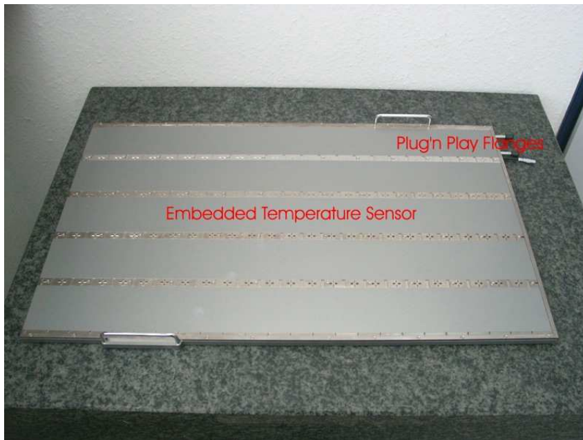
Abb. 2. Das herausnehmbare Slide-Tablett kann einfach (z. B. zum Be- und Entladen) von den Kühlschläuchen des Thermostats abgezogen werden. Der hier gezeigte Tray wird in der verlängerten Plattform, d. h. dem Nano-Plotter NP 2.0/E, benutzt, und enthält kleine Noppen, mit denen die Slides positioniert werden. Die Noppen können durch Herausschrauben der Metallstreifen auch entfernt werden.
