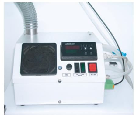
Ultraschallbefeuchtungssystem für eine stufenlose Befeuchtung bis 80 % rel. Luftfeuchtigkeit.
